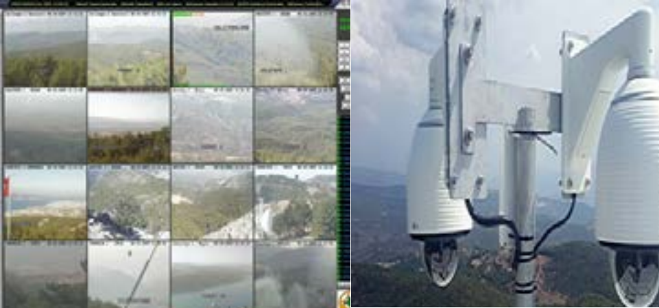
Şekil 4. İnsansız kule ve görüntülerin merkeze aktarılması
